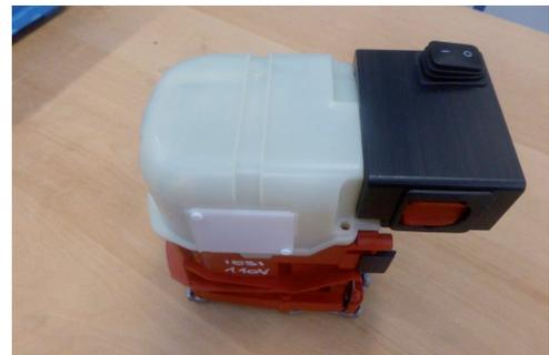
Motor-Tester aufgesteckt auf Motor
